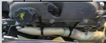
Утеплитель крышки фильтра картерных газов
